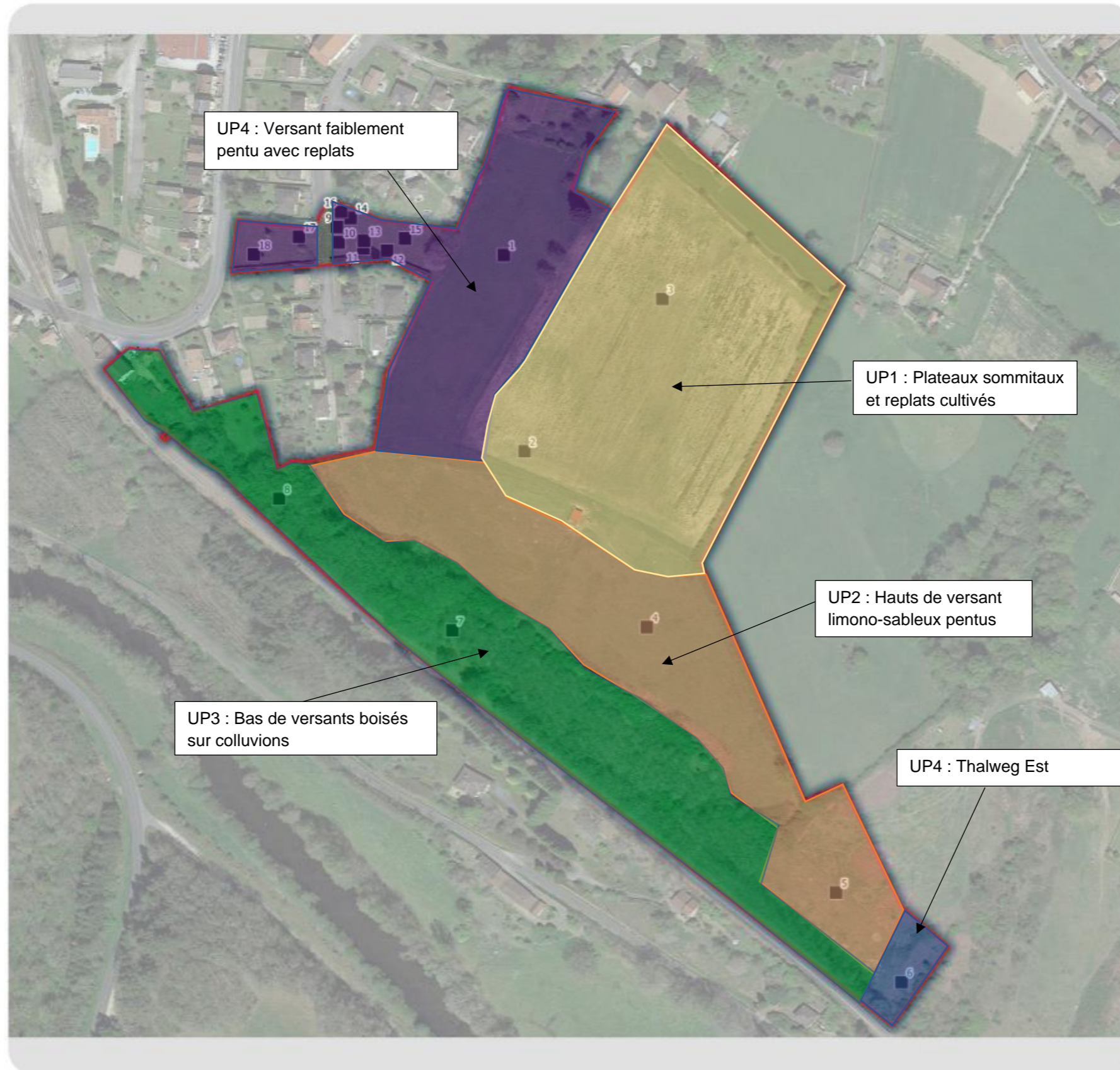
Illustration 2 : répartition des sondages par rapport aux unités pédologiques définies en première approche (source : ECTARE)
